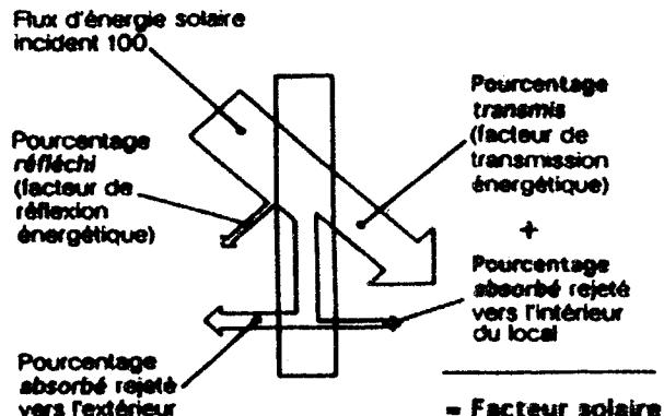
Il est à noter que le choix du type de vitrage devrait favoriser un coefficient de transmission du **rayonnement solaire visible** le plus élevé possible pour un même coefficient « FS » et ce, pour assurer au mieux l'éclairage naturel des locaux.
